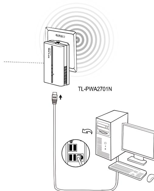
图2-3 终端连接图
